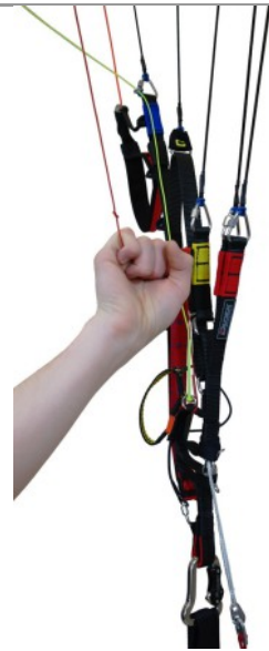
4 Sterowanie za pomocą linki TEA (trymery częściowo lub całkowicie odpuszczone).
