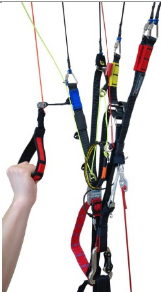
1 Sterowanie samym uchwytem sterowniczym (trymery zaciągnięte).
