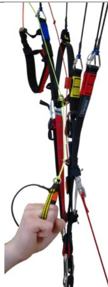
3 Sterowanie za pomocą uchwyty TST (trymery częściowo lub całkowicie odpuszczone).
