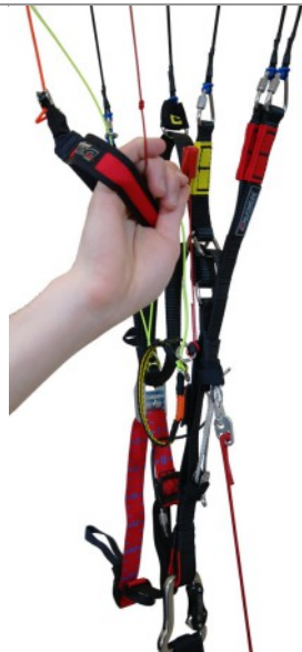
2 Sterowanie uchwytem sterowniczym i linką TEA jednocześnie (trymery częściowo odpuszczone).
