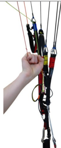
4 Pilotage aux TEA (trims partiellement ou complètement ouverts - mode accéléré)
