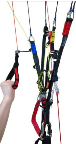
1 Pilotage aux freins (trims fermés - mode lent)
