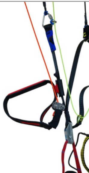
4 Poulie en troisième position (basse), aimant EK placé au dessus de la boucle de trim.
