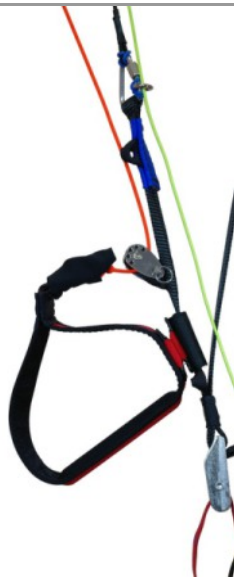
3 Poulie en seconde position (médiane), aimant EK placé au dessus de la boucle de trim.
