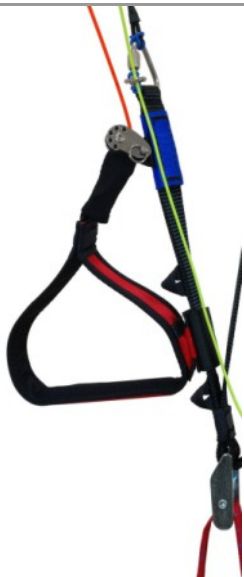
2 Poulie en première position, Aimant EK placé au-dessus de la boucle de trim.
