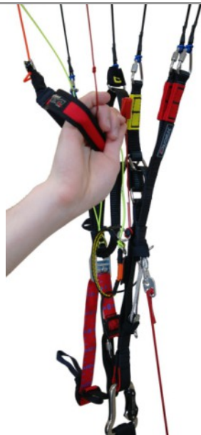
2 Poignées de frein + ligne TEA (trims partiellement ouverts - mode accéléré)
